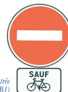
Signalisation verticale de l'entrée du double-sens cyclable (M9v2 sous le B1)
