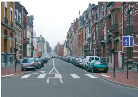
Exemple de signalisation de la sortie d'un double-sens cyclable - Source : CETE Nord-Picardie
