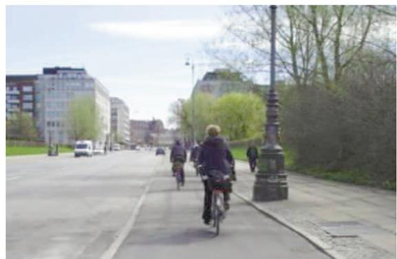
La largeur est à adapter en tenant compte des objectifs locaux, du contexte (bâti ou non bâti) et de la fréquentation attendue de l'aménagement. Des surlargeurs peuvent s'avérer utiles, par exemple en montée ou en virage.
